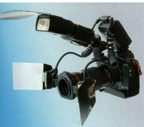
О Комплекте из макровспышки MT-24EX с дополнительной вспышкой Speedlight 550EX и простейшими отражателями для работы с сильно бликующими насекомыми
